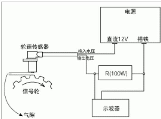
2. 比较轮速传感器输出电压的变化与如下所示的正常输出电压的变化。
