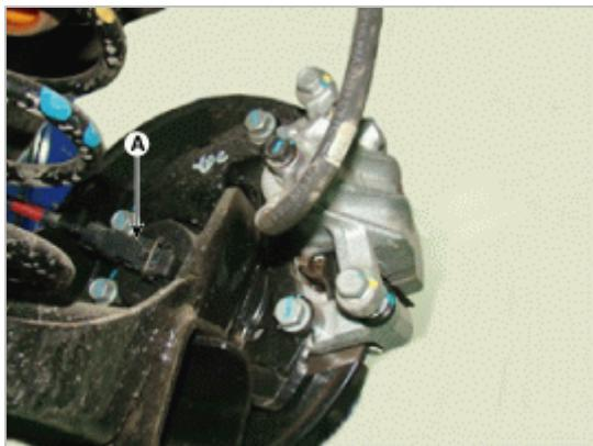
2. 拆卸后轮速传感器。(参考驱动轴和车桥-后桥总成)
